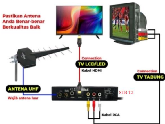
Gambar 2. Skema diagram pemasangan STB
