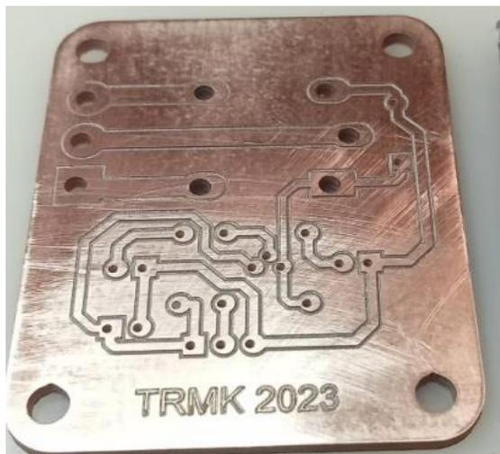
Gambar 9. Hasil Layout PCB dengan Mesin CNC
