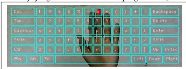
Gambar 8 Tampilan tangan yang terdeteksi didalam sistem virtual keyboard
