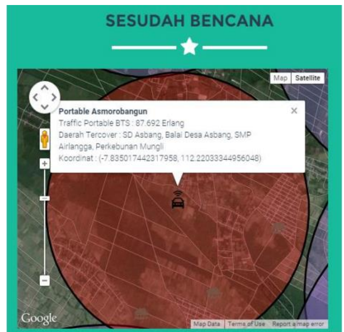
Gambar 13. Peletakkan Portable Base Station di sekitar BTS Asmorobangun
