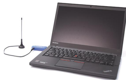
Gambar 1. Koneksi RTL-sdr ke laptop
