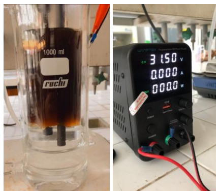
Gambar 4. Proses Transesterifikasi Menggunakan Elektroda Grafit
