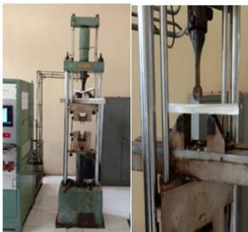
Gambar 3. Pengujian kuat lentur papan gipsum berpenguat serat karung plastik bekas.
