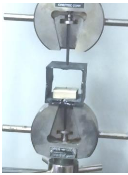
Gambar 2. Pengujian kuat tarik sekrup
