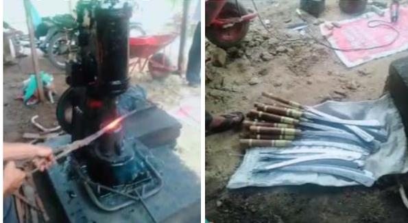
Gambar 4 Proses Penempaan Mesin Tempa (*Forging hammer*) dan Hasilnya.
