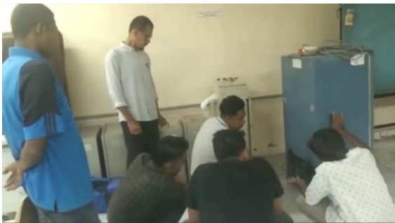
Gambar 6 Peserta pelatihan sedang melakukan pengujian kerja kulkas setelah pengisian freon
