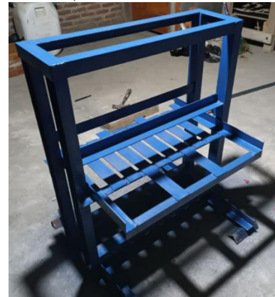
Gambar 8. Alat pemecah bata ringan (media filter biologis)
