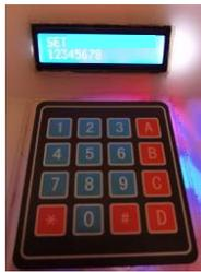
Gambar 6. Hasil Pengujian *Keypad* 4x4 Pada Modul Pengering Cascara Dengan Tampilan LCD
