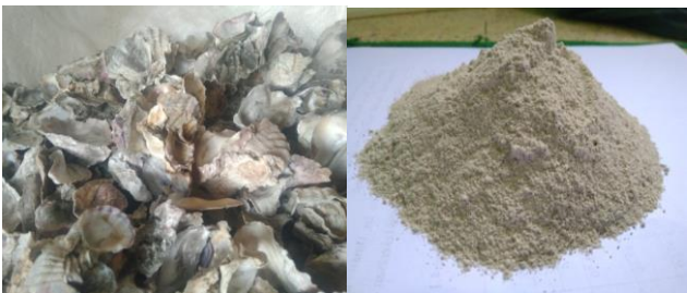
Gambar 4. Katalis yang berasal dari cangkang tiram
