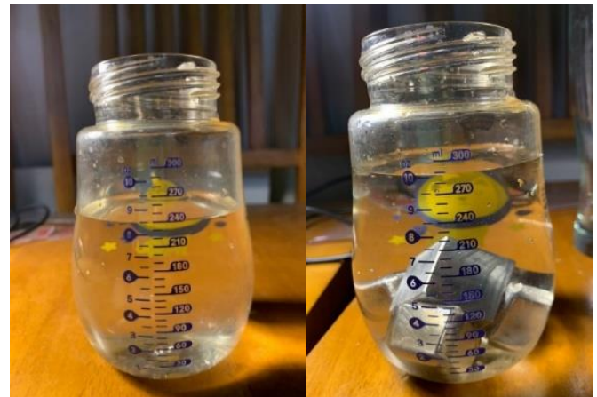
Gambar 10. Gelas ukur berisi air 240 ml (kiri) dan gelas ukur dicelupkan spesimen (kanan)
