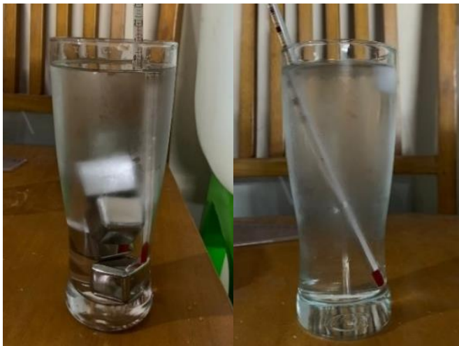
Gambar 12. Konfigurasi gelas, spesimen dan termometer pada pengujian
