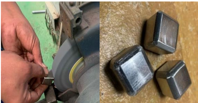
Gambar 8. Proses pembuatan fillet (kiri) dan spesimen setelah dibuat fillet (kanan)
