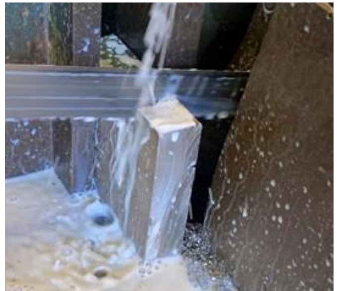
Gambar 4. Proses pemotongan pelat stainless steel
