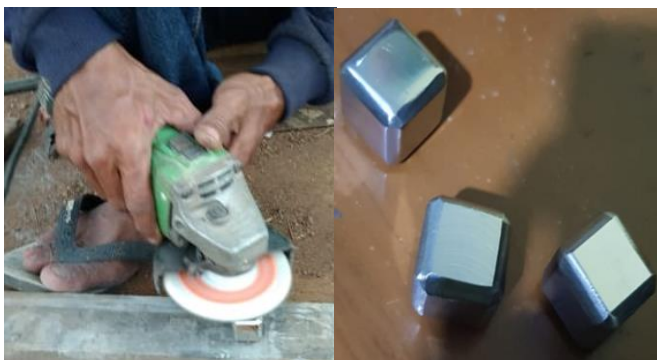
Gambar 9. Proses menghaluskan permukaan (kiri) dan hasilnya (kanan)
