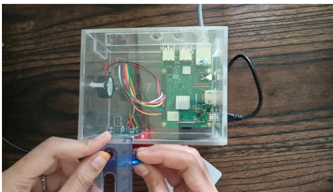
Gambar 8. Pengukuran Jarak RFID tag Tipe Gantungan Kunci
