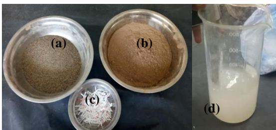
Gambar 1. Material (a) Pasir, (b) *Fly ash*, (c) serat *polypropylene*, (d) Alkalin aktivator
