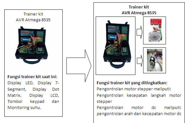
Gambar 1. Diagram blok trainer kit AVR Atmega 8535 sebelum dan setelah penelitian
