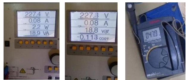
Gambar 2.12. Pengukuran V, I, P, S, Q, cos pi dan intensitas cahaya prototype LED
