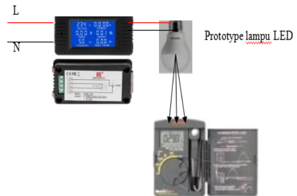
Gambar 2.11. Pengukuran daya dan intensitas cahaya.
