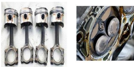
Gambar 6. Efek knocking terhadap komponen mesin
