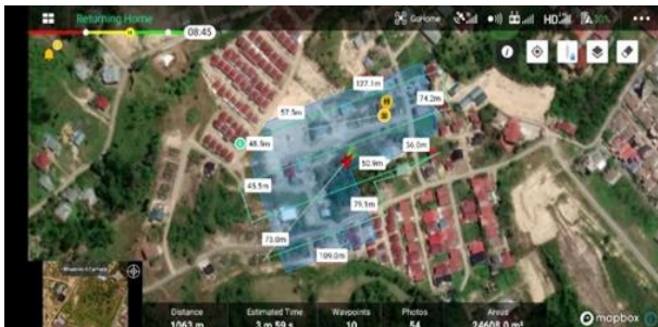
Gambar 2. Tampilan Aplikasi DJI Pilot Version v1.9.0 berbasis Android saat Melakukan Survey Pengambilan Foto-foto Udara
