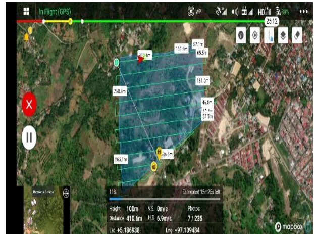
Gambar 2. Tampilan Aplikasi DJI Pilot Version v1.9.0 berbasis Android saat Melakukan Survey Pengambilan Foto-foto Udara
