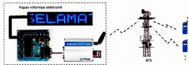
Gambar 1 konfigurasi sistem papan informasi elektronik [2]
