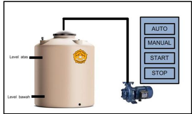
Gambar 11. Sistem Pengisian Air pada Tanki
