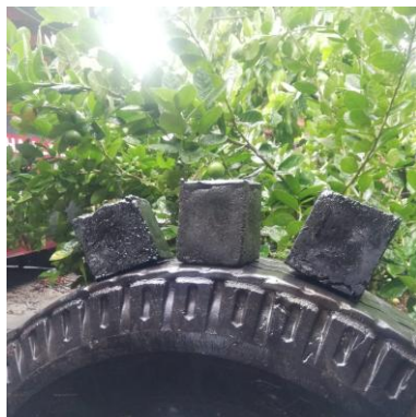
Gambar 3. Paving block berbahan plastik 75% dan pasir laut 25%
