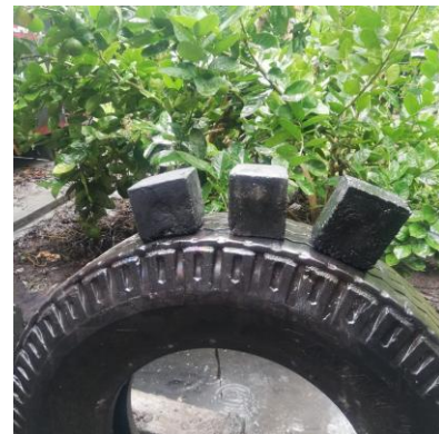
Gambar 4. Paving block berbahan plastik 50% dan pasir laut 50%
