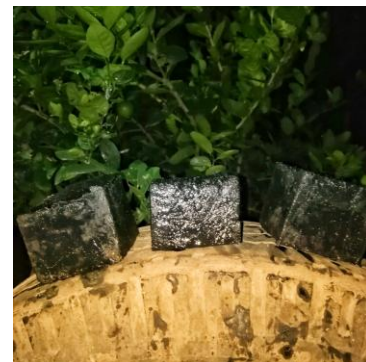
Gambar 5. Paving block berbahan plastik 60% dan pasir laut 40%
