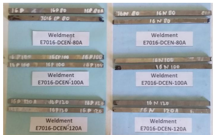
Gambar 3. Spesimen area lasan elektroda E7018 dan E7016
