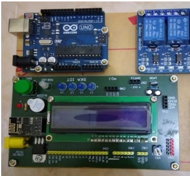
Gambar 5. Modul sistem telemetri dan sistem peringatan dini berbasis IoT
