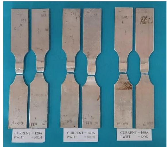
Gambar 9. Gambar spesimen Uji Tarik
