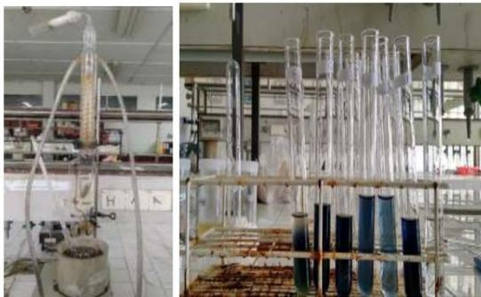
Gambar 8. Uji Kadar lemak dengan menggunakan Alat Soxhlet
