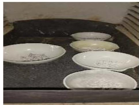
Gambar 6. Proses Pengujian Kadar Abu
