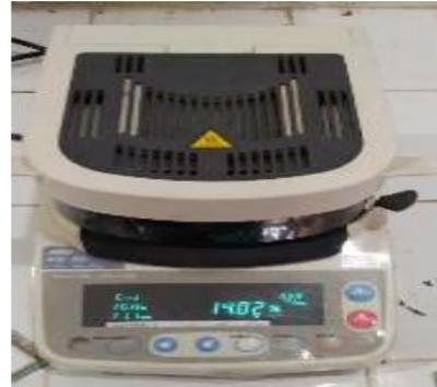
Gambar 10. Proses Pengujian Kadar Air
