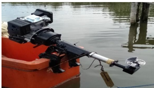
Gambar 16. Pengujian Propeller Konvensional
