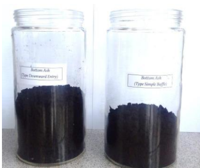
Gambar 6. Partikel polutan yang dihasilkan oleh kedua separator
