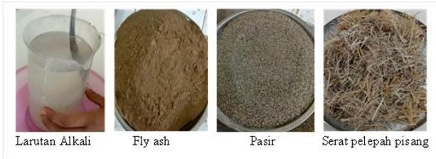
Gambar 1. Material pembentuk mortar geopolimer serat
