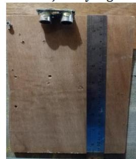
Gambar 4 Pengujian Sensor Ultrasonik dengan Mistar
