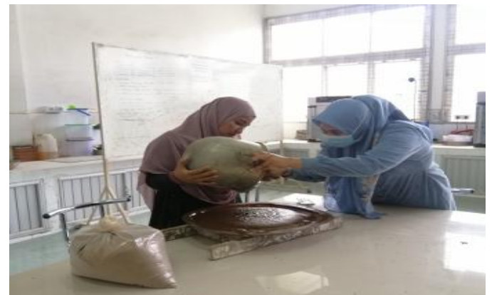
Gambar 7. Penuangan Campuran ke Cetakan
