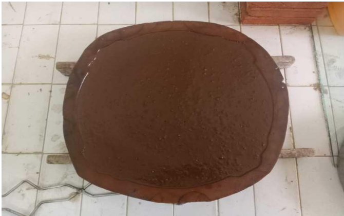
Gambar 8. Campuran Panel setelah dituangkan ke Cetakan
