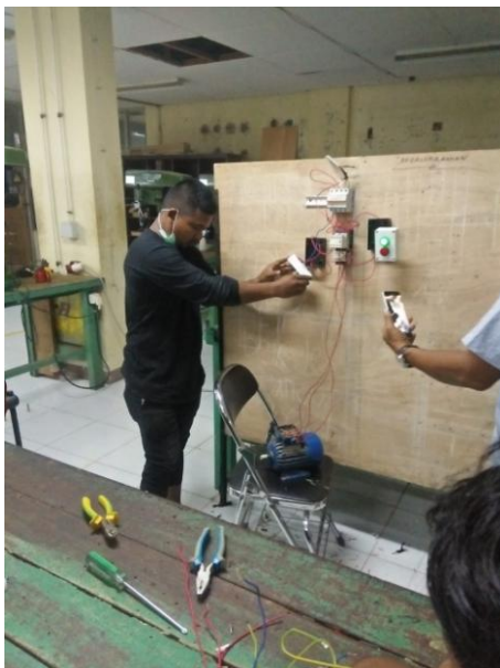
Gambar 9 Salah satu peserta sedang mencoba merangkaian rangkaian kontrol dan rangkaian daya instalasi listrik tenaga (motor listrik 3 fasa)
