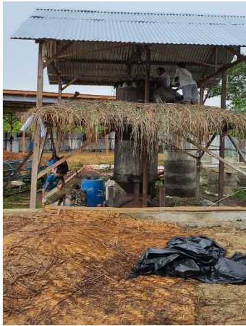
Gambar 11. Proses Penyulingan Minyak Sereh Wangi Dengan Metode Steam Destilasi
