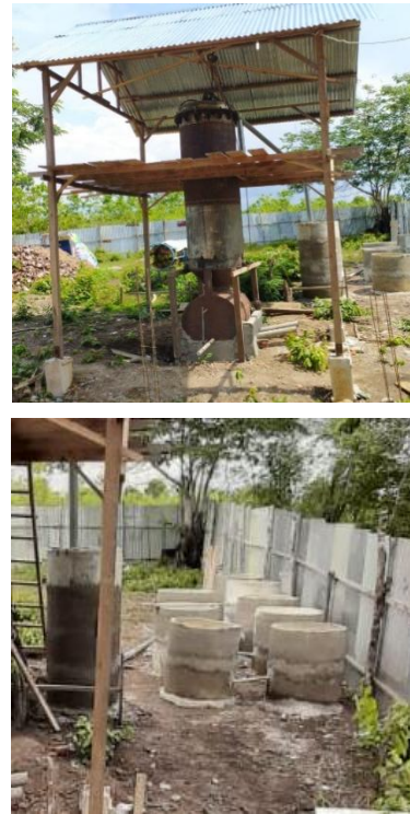
Gambar 2. Alat penyulingan minyak serai wangi kapasitas 500 kg
