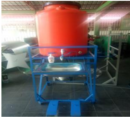
Gambar 4. Westafel semi otomatis yang dilengkapi dengan handle pembuka kran air dan penekan sabun cair
