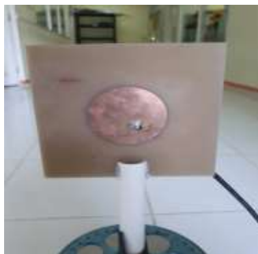
Gambar 5 Hasil pabrikasi antenna mikrostrip patch lingkaran
