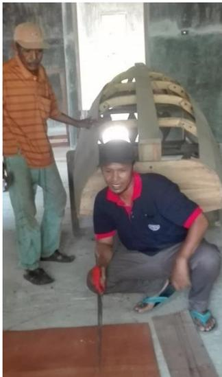
Gambar 3.2. Pembuatan Rangka Perahu Triplek.
