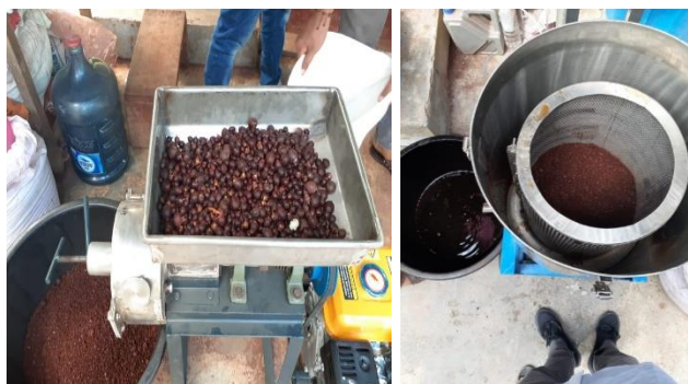
Gambar 9. Praktek Penggunaan Mesin Penghancur buah jernang dan mesin centrifuse pemisah air dan jernang.
