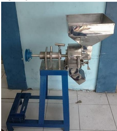
Gambar 7. Mesin penghancur buah jernang
