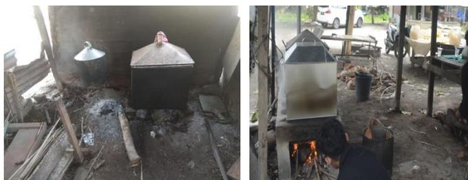
Gambar 7. Perbandingan tungku lama dengan tunggu hemat energi
