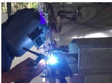
Gambar 7. pemasangan engsel
