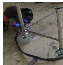
Gambar 3. Proses pengelasan kerangka Alat *Autoclave*
