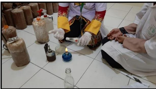
Gambar 3. Cara memegang botol yang steril
