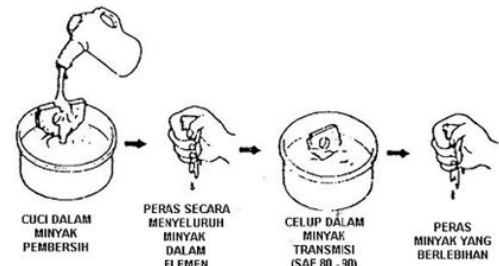
Gambar 7 Urutan pencucian elemen saringan udara
