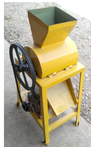
Gambar 8. Mesin pengupas kulit buah melinjo yang telah difabrikasi
