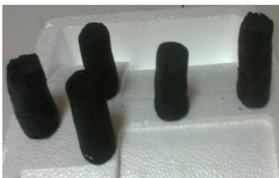
Gambar 9. Briket Superkarbon siap digunakan
