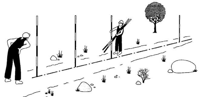
Gambar 2. Sketsa penyetingan garis as/tengah jalan
