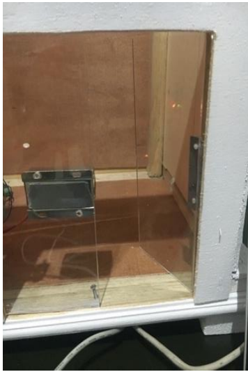
Gambar 9. Kondisi Selenoid Terbuka
