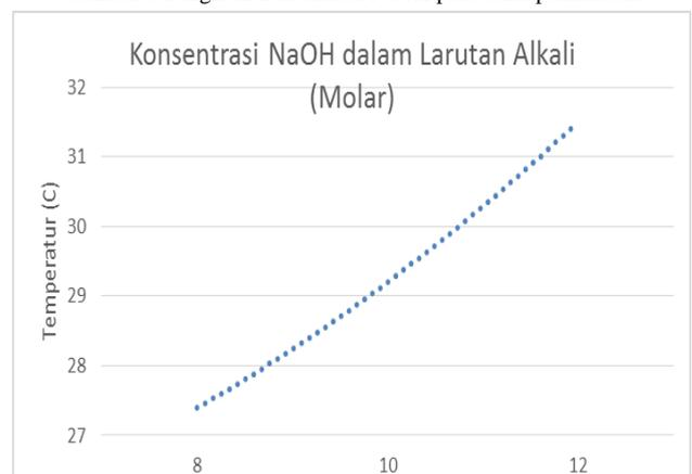
Gambar 4 Pengaruh konsentrasi NaOH pada suhu pemanasan larutan alkali
