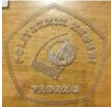
Gambar 28. Hasil Pengujian Pembuatan Logo PNP Dari gambar 27 dan 28, kesalahan hasil terhadap desain mempunyai kesalahan rata – rata 2 %.
