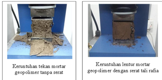
Gambar 8. Perbandingan keruntuhan akibat uji tekan
