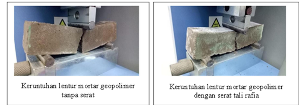
Gambar 6. Perbandingan keruntuhan akibat uji lentur
